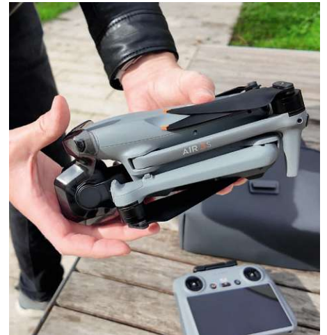
Sehr kompakt Die DJI Air 3S wiegt 724 Gramm und misst 21 x 10 x 9 Zentimeter. Für den Transport lässt sie sich platzsparend zusammenklappen.
