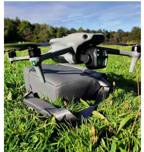
Objektivauswahl Die Kameradrohne DJI Air 3S ist mit einem Weitwinkelobjektiv (24 mm) und einem Teleobjektiv (70 mm) ausgestattet.
